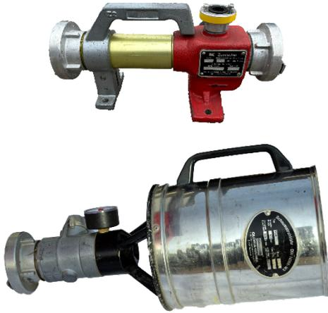
Der Zumischer dient zum Hinzufügen von Schaummittel zum Löschwasser. Mit einem D-Saugschlauch wird das Schaummittel aus einem Kanister gesaugt. Das Schaumrohr dient zum Aufbringen von Schaum. Zum Wasser-Schaummittel-Gemisch wird Luft zugeführt und es entsteht Löschschaum.
