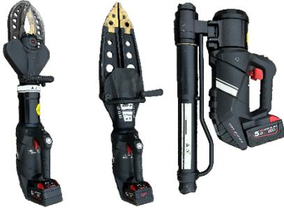
Dienen zum Befreien von eingeklemmten Personen aus verunfallten Fahrzeugen. Zu den hydraulischen Rettungsgeräten zählen Spreizer, Schere und Rettungszyylinder. Antrieb durch Hydraulikantrieb, Schlauchgebunden oder mit Akku.
