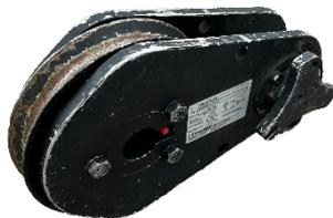
Dient zum Umlenken bzw. zur Änderung der Richtung eines Seiles. Wird mit einem Anschlagmittel wie z.B. einem Schäkel oder einer Schlinge befestigt.
